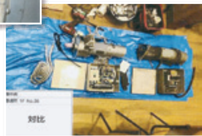
シャッター開閉器の一 交換前(右)、交換 後(左)の比較
